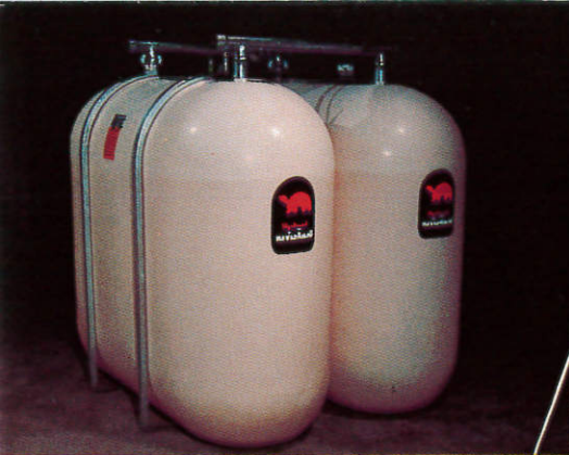
Rivisäiliö 2x1500 litraa. Yhden säiliön mitat: leveys 730 mm, korkeus 1510 mm, pituus 1750 mm, paino 47 kg.
