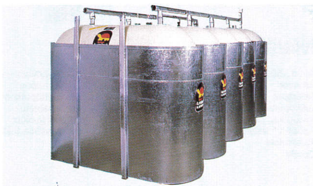
Li-Plast nailon öljysäiliöitä voidaan asentaa sarjaksi 2–5 kappaletta. Sarjasäiliö tuetaan tukevalla kehikolla. Viiden säiliön tilantarve on 185 × 375 cm. Hyväksymispäätös TTL 1141/331/75.
